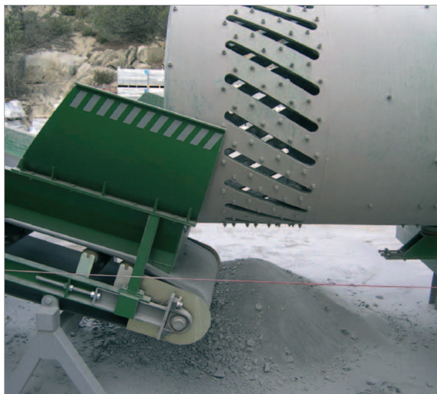
Die Alterungstrommel ist am Auslauf geschlitzt, um den Abrieb abzuschneiden.
