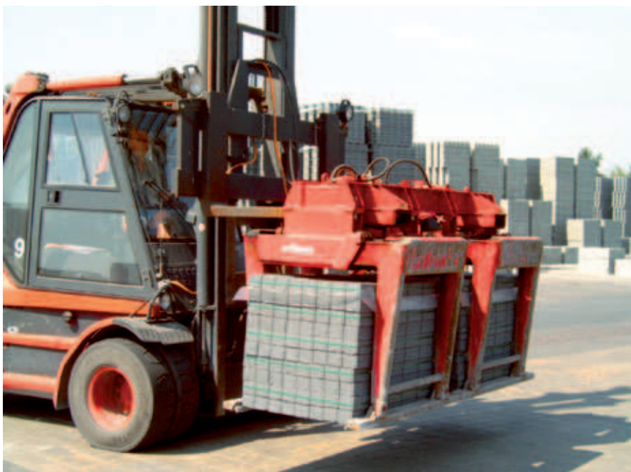
Der Doppelgreifer HGP-3600 besteht aus zwei hydraulischen Einzelgreifern
