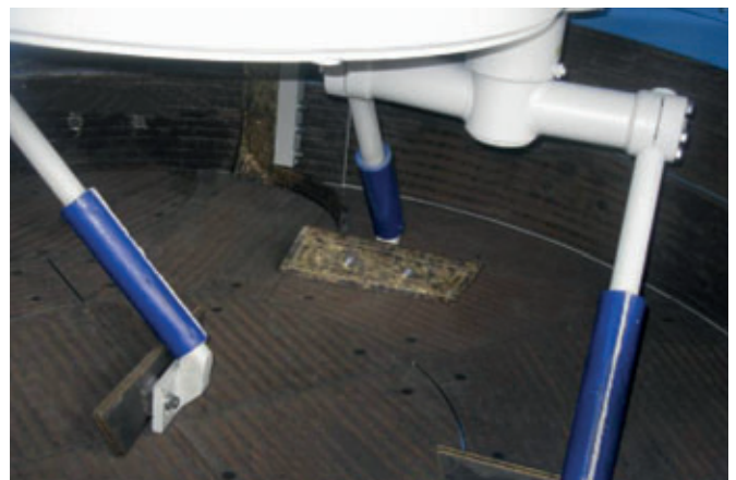
Materialstärken von 2–5 mm auf den Flächen und von 5–10 mm auf dem Kantenbereich der Werkzeuge versprechen eine extrem lange Lebensdauer der Werkzeuge
