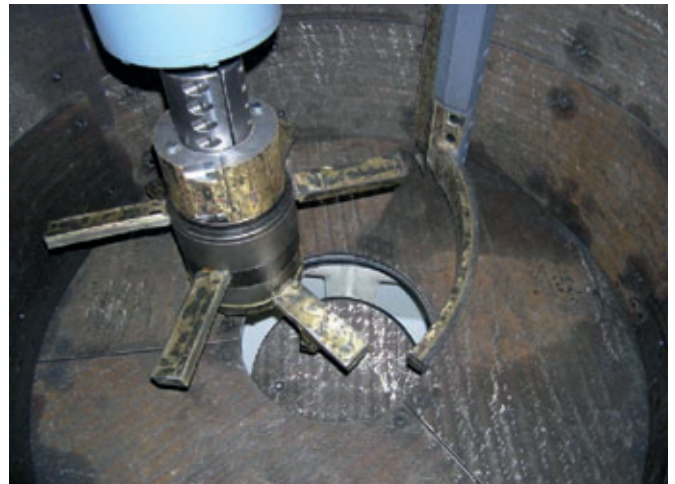
Die Firma Warning liefert mit dem speziell zusammengesetzten Hartmetall bestückte Werkzeuge für jeden Mischertyp
