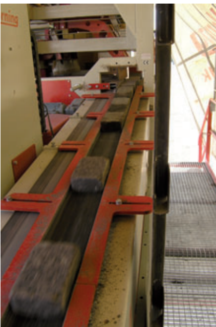
Die Betonpflastersteine und -blöcke laufen mit hoher Geschwindigkeit auf dem Pufferband.
