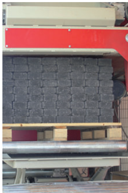
Um eine höhere Stabilität zu erzielen, können die Steine auch horizontal zweiaxial versetzt gestapelt werden.
