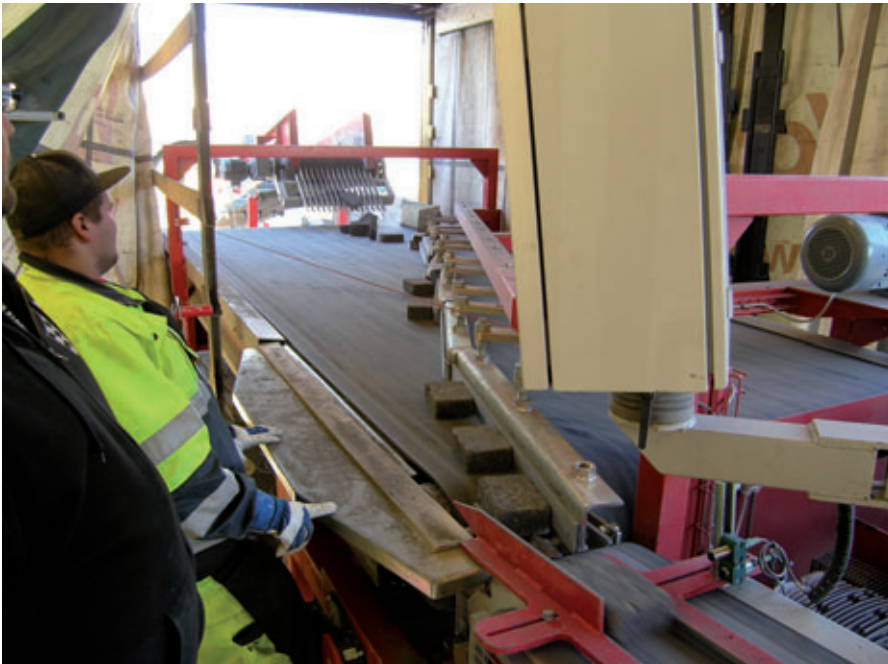
Nach der Trommel werden die gealterten Produkte auf die patentierte Sortieranlage abgegeben.
