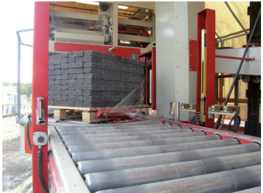
Die geladenen Paletten laufen automatisch auf den Drehkreisel der Verpackungstechnik
