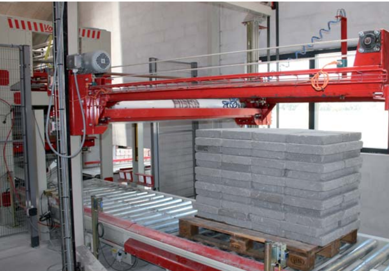
Die planmäßig beladene Palette verlässt den Paketierbereich und kann nun beispielsweise umwickelt werden.
