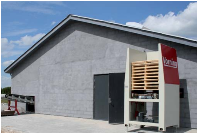
Links im Bild der Sammelcontainer für die abgesplitterten Reste, rechts im Bild das Palettenmagazin.
