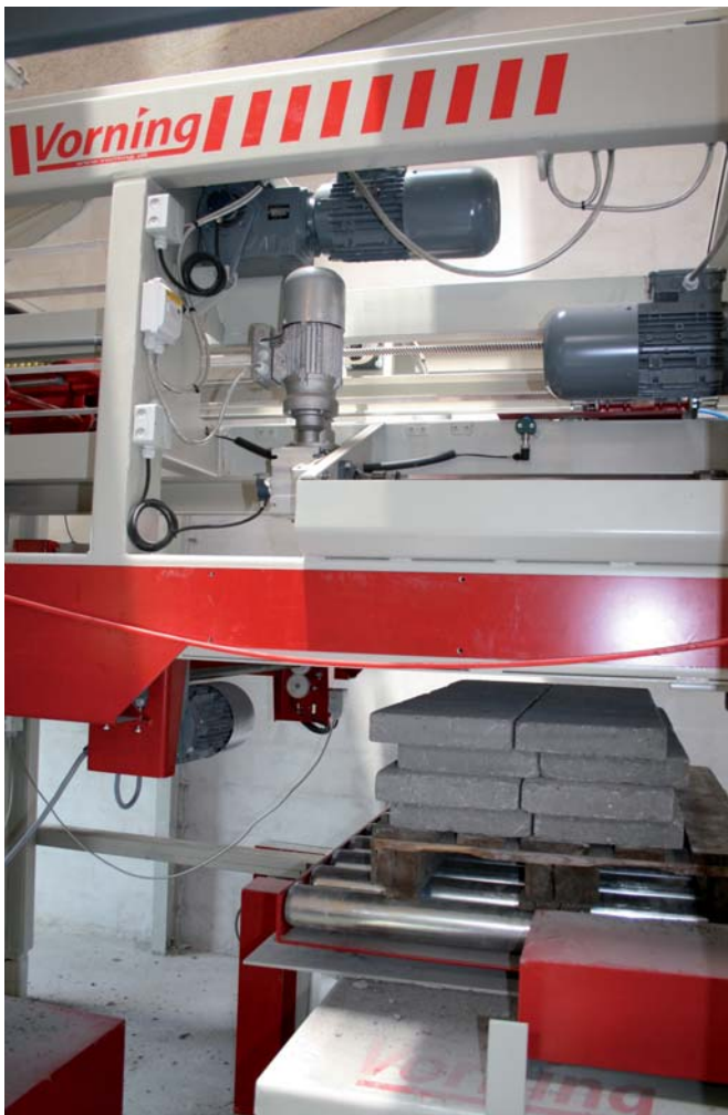
Das Ziehblech übergibt die Pflasterplatten sanft auf die unter dem Ziehblech gelegene Palette ab. Dieser Vorgang wiederholt sich so oft, bis die vom Kunden gewünschte und programmierte Bestückung der Palette erzielt ist.
