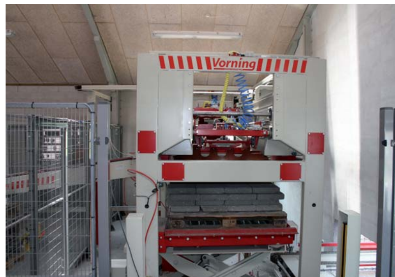
Das Ziehblech übergibt die Pflasterplatten sanft auf die unter dem Ziehblech gelegene Palette ab. Dieser Vorgang wiederholt sich so oft, bis die vom Kunden gewünschte und programmierte Bestückung der Palette erzielt ist.
