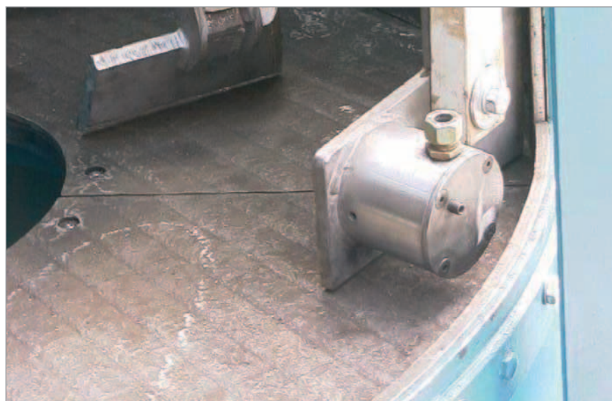
Hochverschleißfester Mischerboden aus Alphachrom 7000 plus, mit extra breiten Schweißraupen planeben gerichtet
