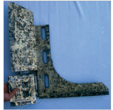
Das Verbundpanzermaterial Alphachrom 7000plus findet auch Einsatz beim Schutz von Mikrowellenfeuchtesonden, um den sensiblen Keramikkopf zu schützen.
