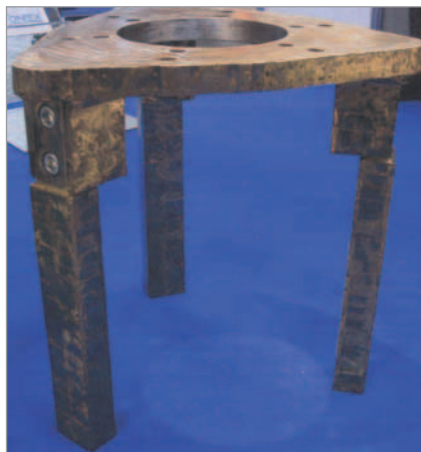
Modifizierter Wirbler mit leicht austauschbaren Wirblerstäben, Widia-bestückt
