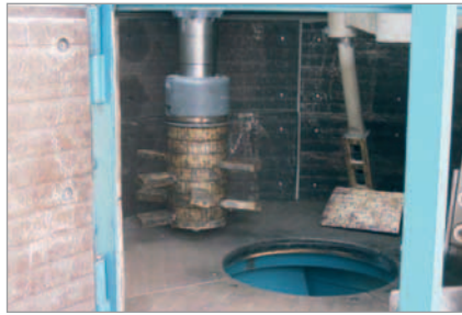
Hochleistungsmischer zur Produktion von Vorsatzbeton mit Wand und Boden aus Alphachrom 7000plus, mit extra breiten Schweißraupen, Mischwerkzeugen und Wirblern mit Widia-Bestückung
